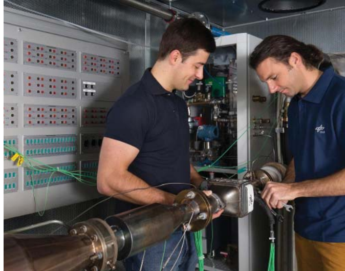
Test des TEG-Funktionsmusters auf dem Heißgasprüfstand
