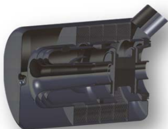
Mikrogasturbine mit schadstoffarmer, FLOX®-basierter Brennkammer
