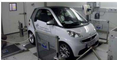
Validierung von Brennstoffzellensysteme
