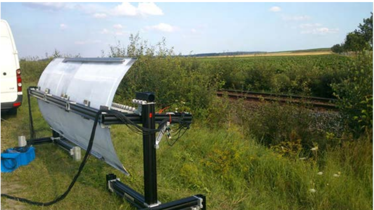
Abbildung 2: Foto des neu entwickelten Mikrofon-Arrays beim Einsatz an der Strecke.
