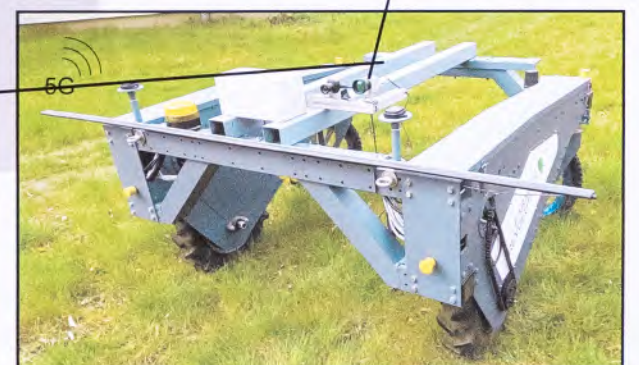
Elektrische autonome Farming GT Sensorplattform mit Kamera und späterem Roboterarm mit Sensorwürfelmagazin
