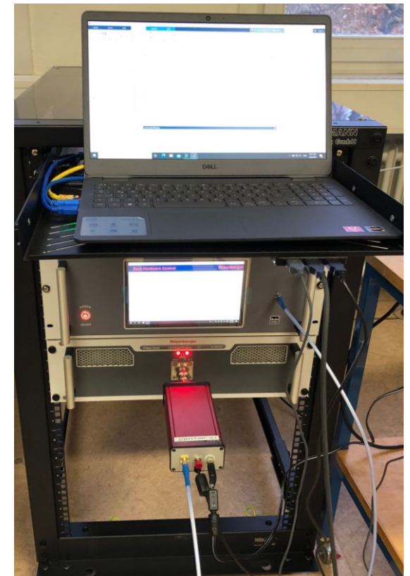
Phasenreferenz und Leistungssensor während der Kalibrierung des PIM-Systems
