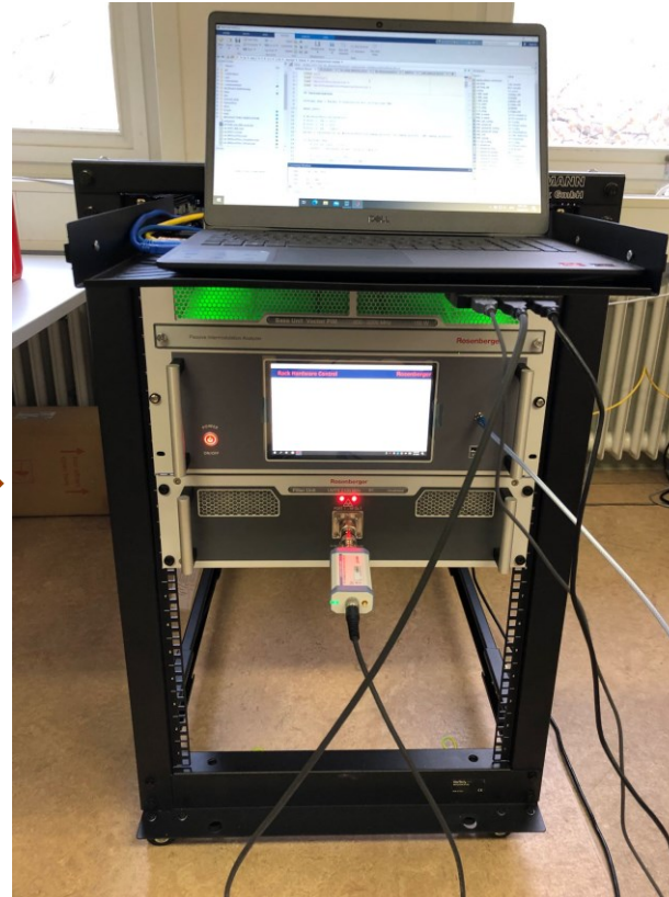
Phasenreferenz und Leistungssensor während der Kalibrierung des PIM-Systems
