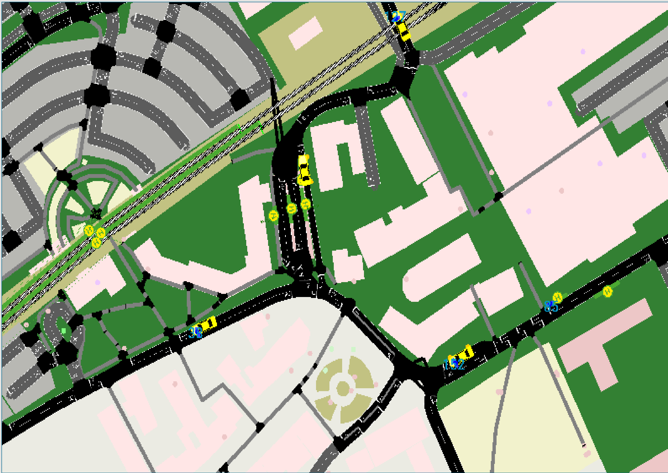
Simulationsmodell Salzgitter-Bad im open source DLR-Tool SUMO (Simulation of Urban Mobility); Quelle: DLR
